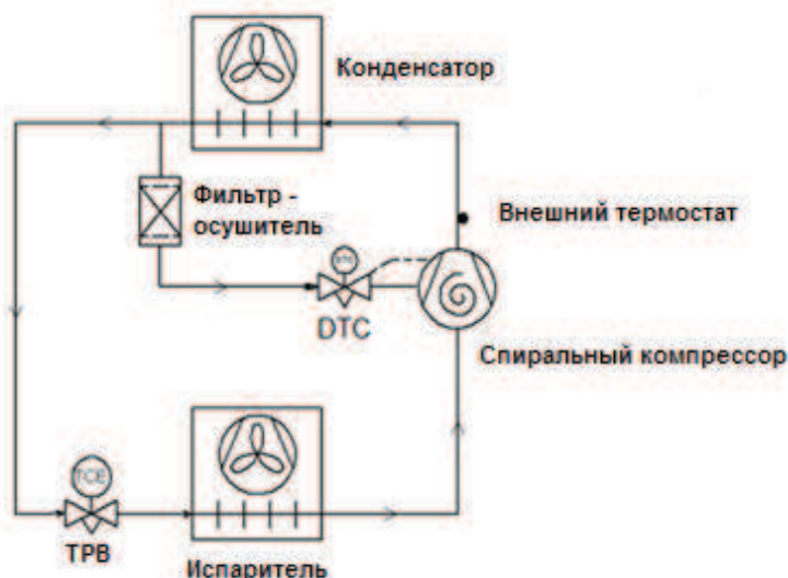
Рис. 4: Впрыск жидкости с помощью вентиля DTC
